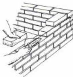
Figura 7 - Colocação da argamassa de assentamento
